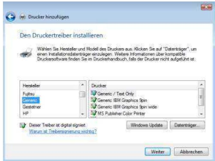
5. Es öffnet sich das „Druckersoftware installieren“ Untermenü. Hier wählen Sie auf der linken Seite unter Hersteller – „Standard“ und unter Drucker: „Generic / Text Only“ und klicken dann auf „weiter“.
