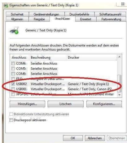
**Probieren Sie alle möglichen Anschlüsse (USB001 USB002 USB003 USB004 usw.) nacheinander, bis der Drucker anfängt zu drucken!**
